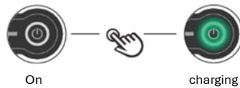
El proceso de carga se inicia automáticamente (después de 1 minuto como máximo).
